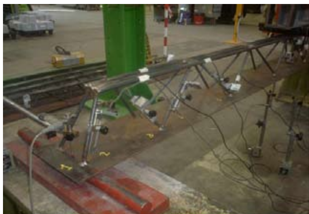
Figura 4: dettagli di una trave in fase di prova con flessimetri ed estensimetri.
