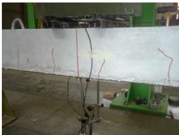
Figura 8: fessurazioni a rottura per flessione
